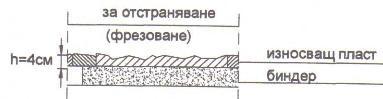
ДЕТАЙЛ No1 - Фрезование на повредени площи
